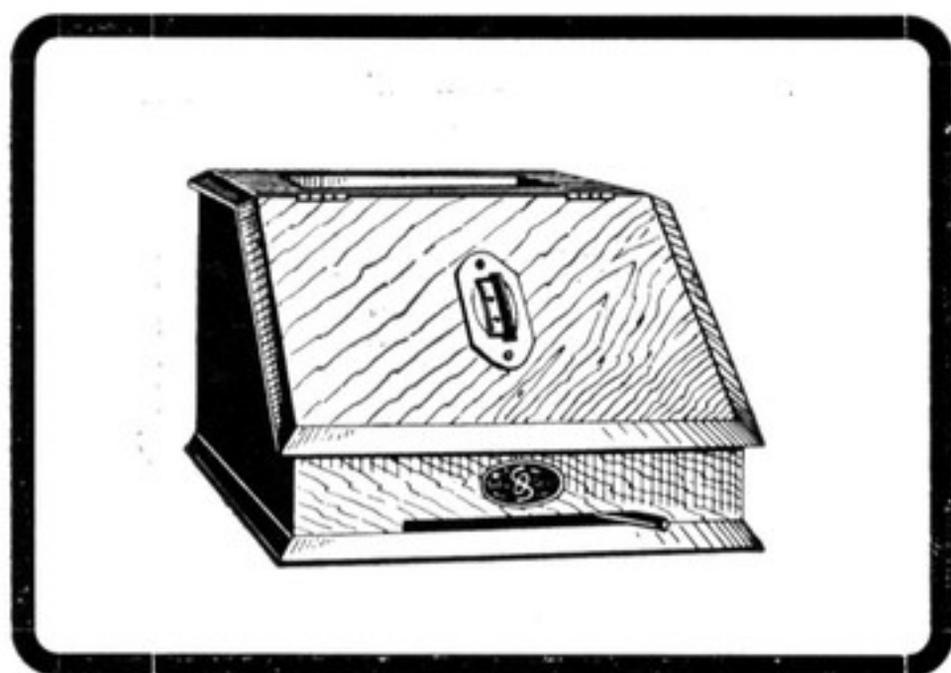
Dieser Dreiröhrenempfänger ist mit komplettem Netzanschluß für Wechselstrom ausgestattet, so daß für ihn weder ein Akkumulator, noch eine Anodenbatterie benötigt wird. Er besitzt die gleichen Leistungen wie meine Orts- und Überlandempfänger. Die Spulen für den Wellenlängenbereich von 200-2000 m sind eingebaut. Ein besonderer Vorteil des Gerätes besteht darin, daß bei eingeschaltetem Empfänger eine Berührung mit irgendwelchen Spannung führenden Teilen unmöglich ist.
